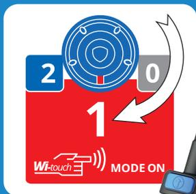
Per attivare la modalità **WI-TOUCH** è sufficiente impostare il selettore di controllo sulla posizione **1**.
