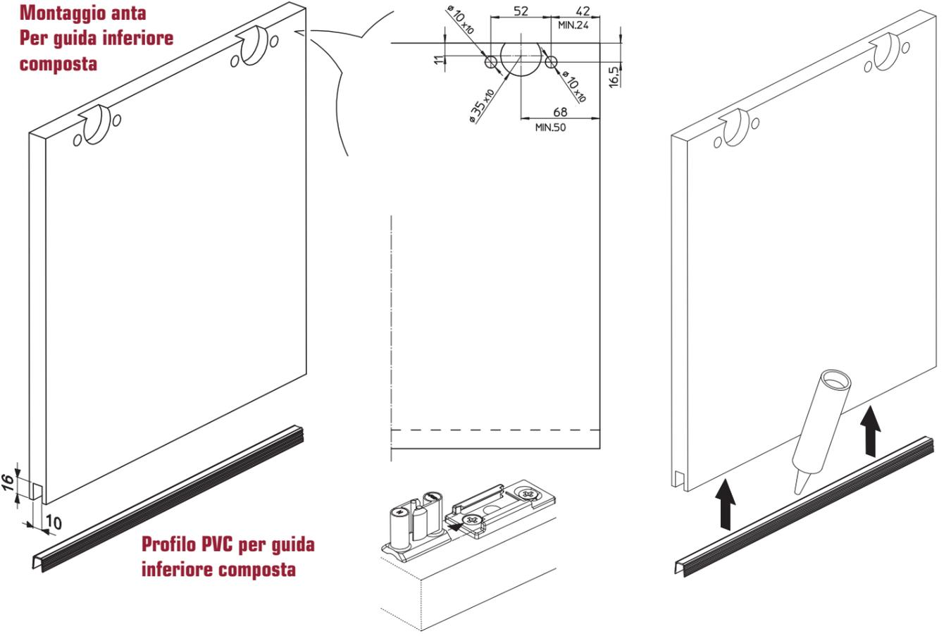
**Inserimento carrelli e fermi con binario pre fissato, valido per tutti i tipi di profili**
