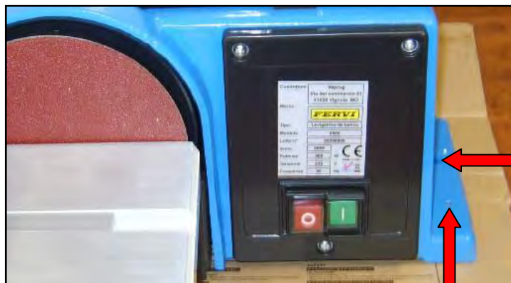
Figura 10 – Dettaglio fori di fissaggio.
