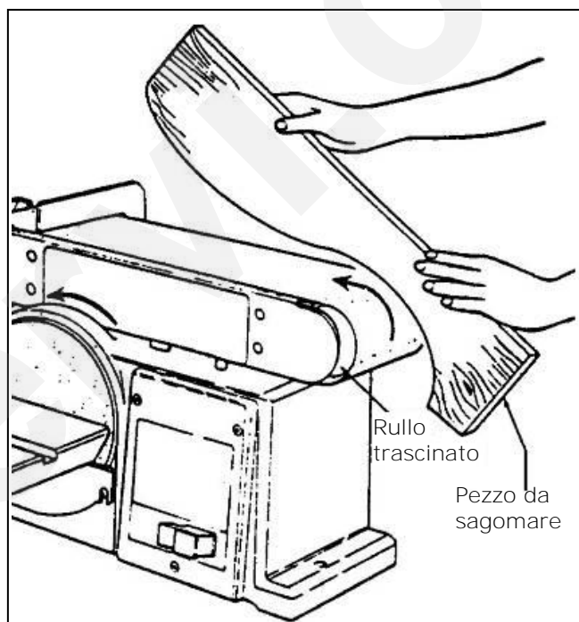
Figura 19 – Levigatura di superfici curve.
