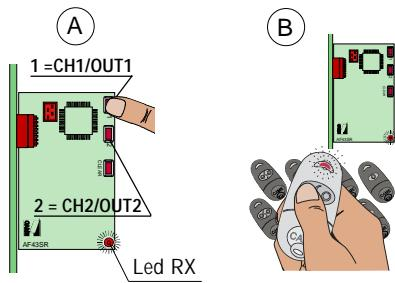
**D** 1 - Eine Taste zum Speichern vom Code 2 Sekunden lang drücken, bis das LED RX zu **blinken** anfängt (Abb. A).
