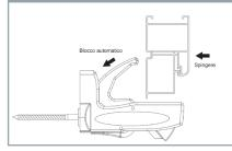
Per il bloccaggio del serramento spingere quest'ultimo in direzione dello Shark. Il sistema si bloccherà automaticamente. Nel caso in cui un soffio di vento spingesse il serramento verso lo Shark avremo lo stesso risultato.
