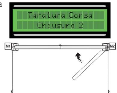
5) ...successivamente l'anta del secondo motore, eseguirà una manovra di apertura fino alla battuta d'arresto....
