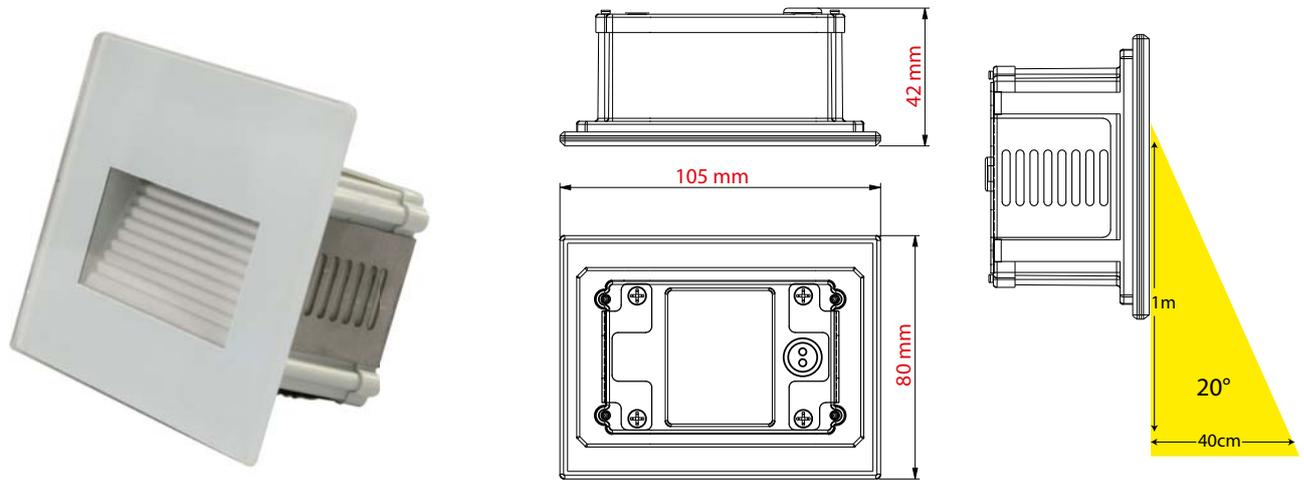
Luci di cortesia da incasso a parete con luce asimmetrica orientata verso il basso, ideali per illuminare bordi scale, muretti, passaggi, ecc. Funzionano direttamente con la tensione di rete e possono essere installati anche in esterni poichè dispongono di protezione IP65.
